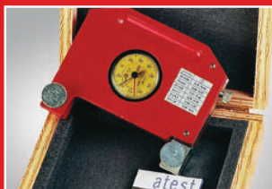
Tenzomat – měření napnutí pásu Tenzomat – measuring of band tension Tenzomat – Bandspannungsmessgerät
