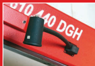
Halogenové osvětlení prac. prostoru Halogen lighting of workspace Halogen-Arbeitsleuchte
