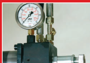
Regulace upínacího tlaku svěráku Vice clamping pressure regulation Spanndruckregulierung
